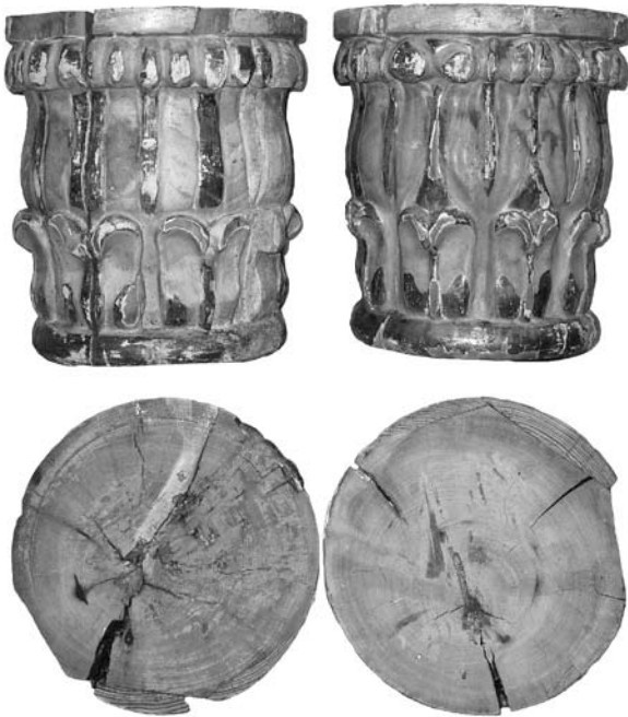
6 iliustracija. Išardyto altoriaus kolonų elementai iš liepos medienos. Skersiniame pjūvyje, trečiosios nuotraukos apačioje ir ketvirtosios nuotraukos viršuje dešinėje matyti priklijuoti pušies medienos gabaliukai. Adomo Vito nuotrauka, 2018
